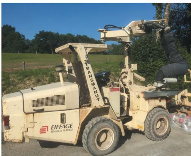
Рисунки 37 и 38. Погрузчик с вакуумным захватом для бордюрного камня
