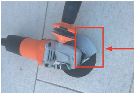
Рисунок 49. Ручная шлифовально-режущая машинка, оборудованная защитой
