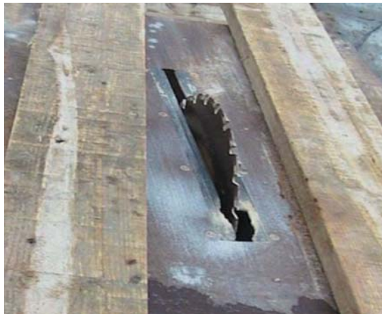
Рисунок 46. Не имеющая защиты циркулярная пила
