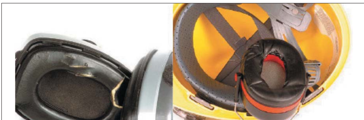
Рисунки 51 и 52. Защитные наушники с неплотно прилегающими и поврежденными подкладками амбушюр
