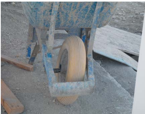
Рисунок 50. Тележка с технически неисправным колесом
