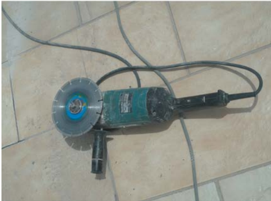
Рисунок 48. Ручная шлифовально-режущая машинка, не оборудованная защитой
