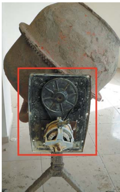
Рисунок 45. Не имеющий защиты приводной механизм бетономешалки
