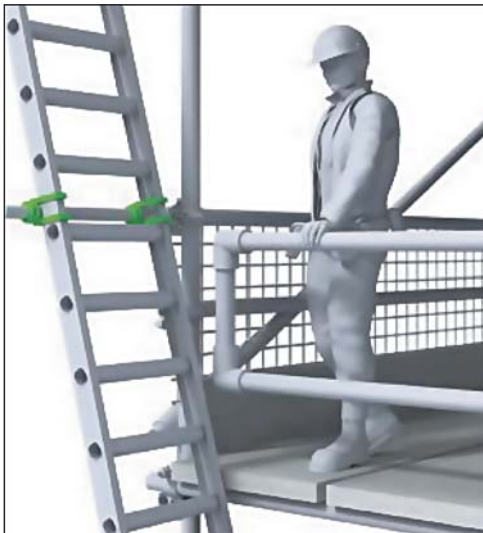
Рисунок 12. Правильно поставленная и зафиксированная лестница у края рабочей площадки
